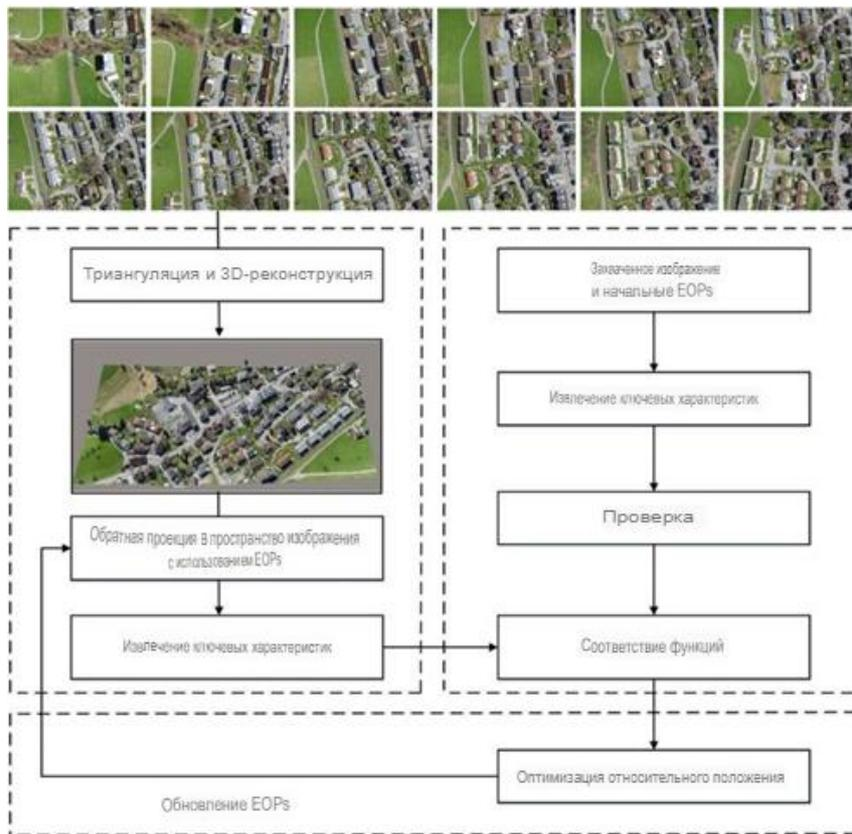
Рис. 1. Блок-схема предлагаемого метода оценки положения камеры
