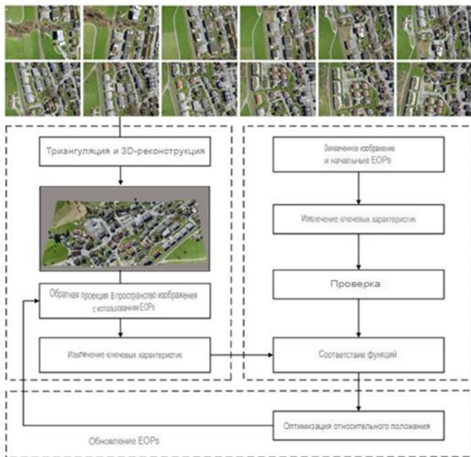
Рис. 1. Блок-схема предлагаемого метода оценки положения камеры
