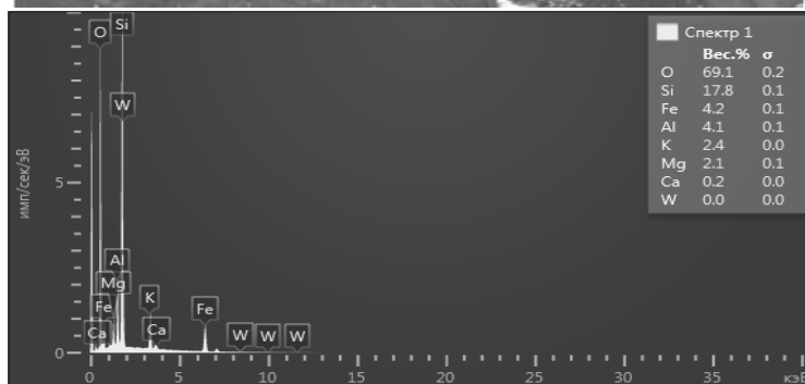
Рис. 2. Электронные микрофотографии (а) и ЭДР-анализ (б) глауконитного порошка Крантау
