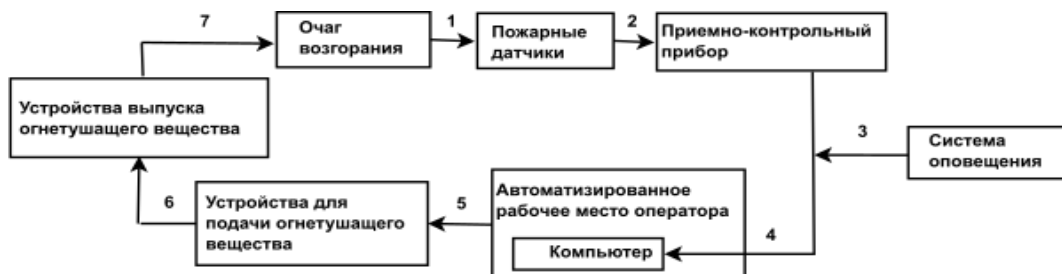
Рис. 3. Структурная схема модели системы пожаротушения с выявлением иерархической структуры
