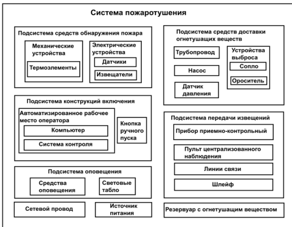
Рис. 2. Формальная модель состава системы пожаротушения
