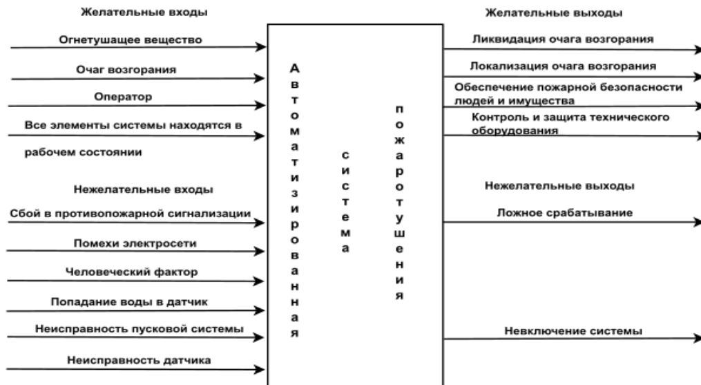
Рис. 1. Модель автоматизированной системы пожаротушения «черный ящик»
