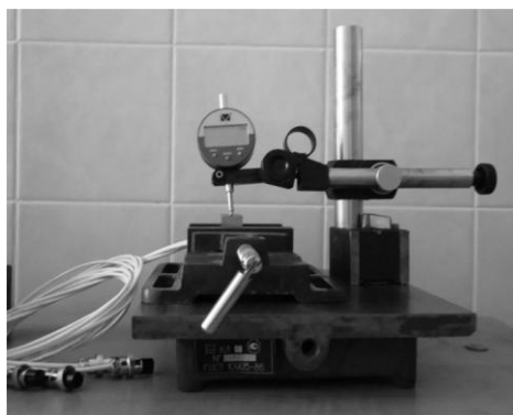
Рис. 2. Приспособление для измерения отклонений от прямолинейности и плоскостности
