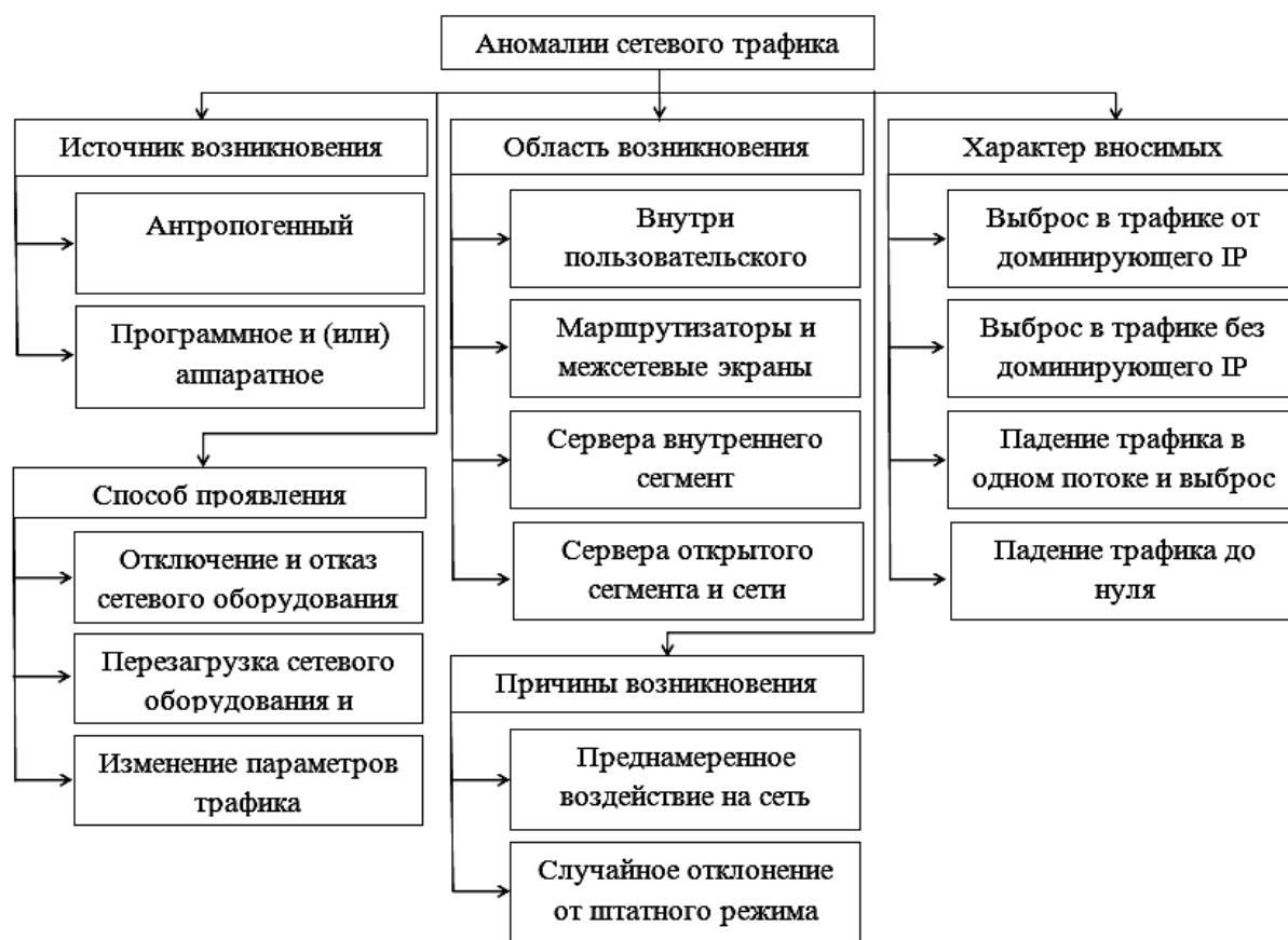
Рис. 1. Классификация аномалий сетевого трафика типа удаленная сетевая атака
