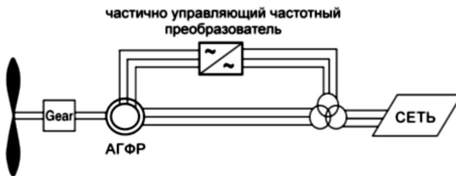
Рис. 4. ВЭУ с ограниченной переменной скоростью с неполным частотным преобразователем
