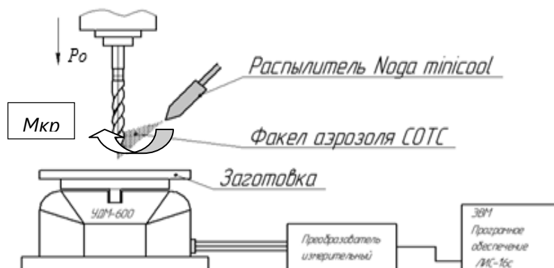
Рис. 2. Схема измерения осевой силы P_o и M_{кр} .
