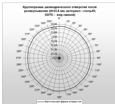
Рис. 3. Отклонение от круглости цилиндрического отверстия: а) после растачивания; б) после развертывания с СОТС – масло минеральное И-20; в) после развертывания с СОТС – масло подсолнечное; г) после развертывания с СОТС – жир свиной
