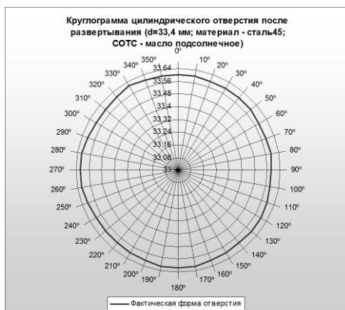
Рис. 3. Отклонение от круглости цилиндрического отверстия: а) после растачивания; б) после развертывания с СОТС – масло минеральное И-20; в) после развертывания с СОТС – масло подсолнечное; г) после развертывания с СОТС – жир свиной
