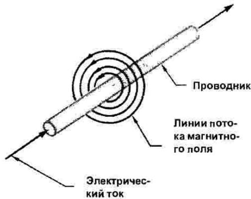
Рис. 2. Движение энергии в проводниках с током
