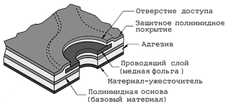
Рис. 1. Односторонняя гибкая печатная плата с упрочнением
