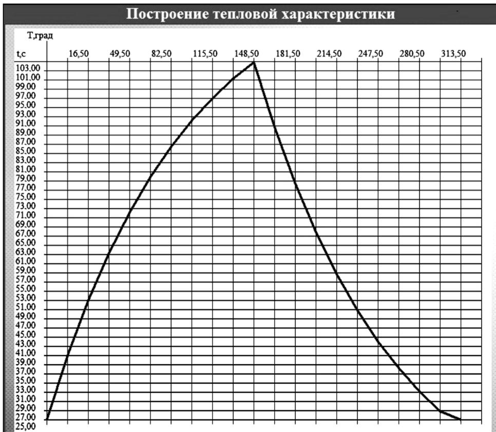
Рис. 4. Окно построения тепловых характеристик кабеля
