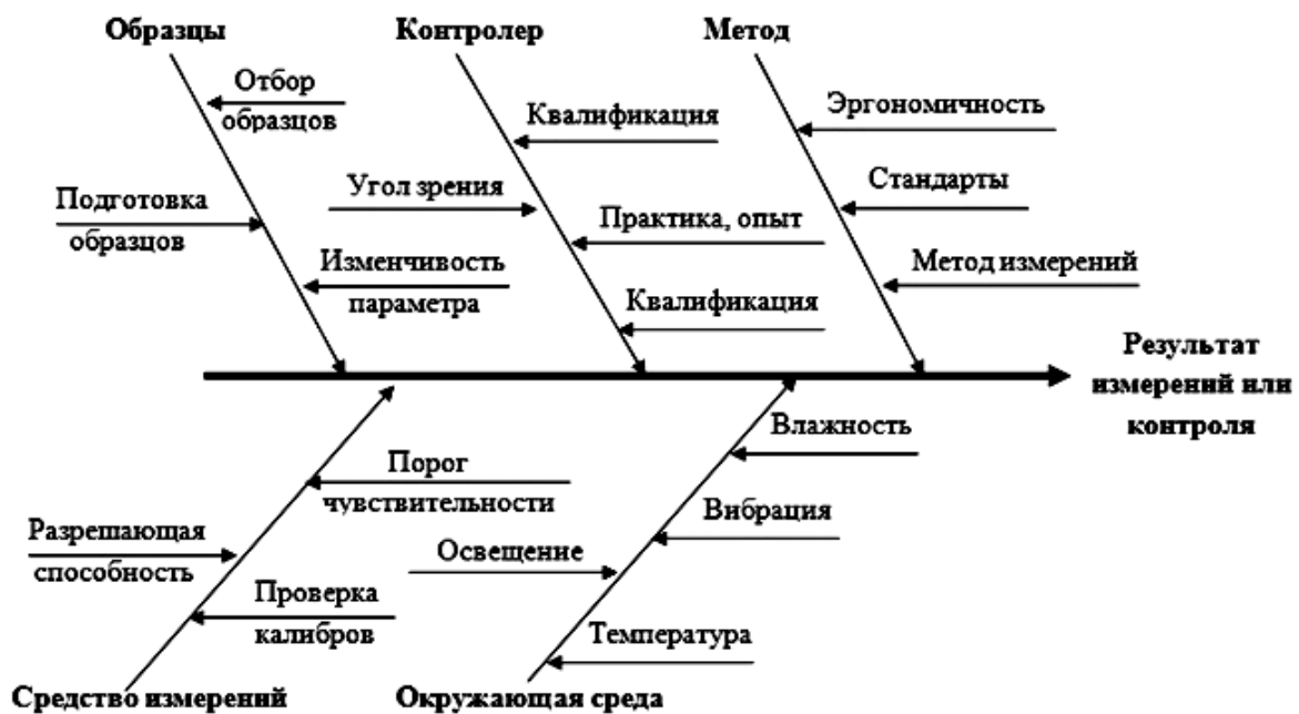
Рис. 2. «Шумы» (вариации) измерительного процесса
