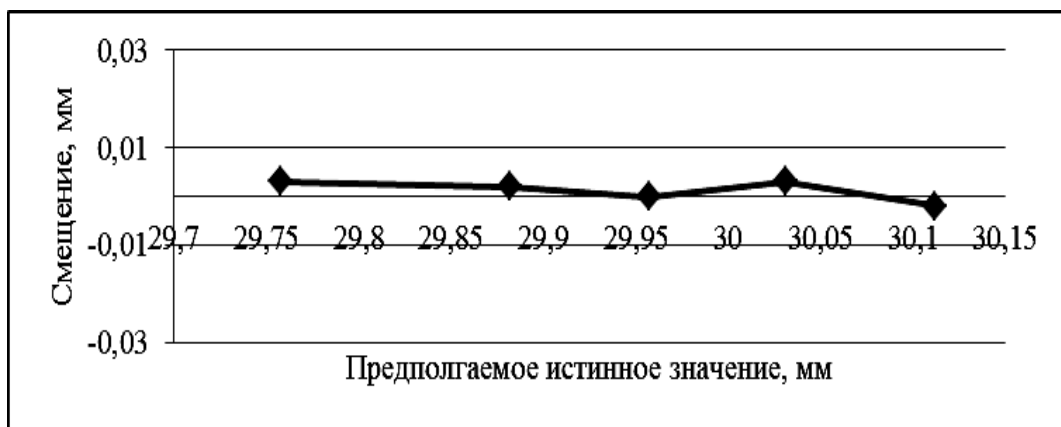
Рис. 4. График линейности смещения измерительного процесса
