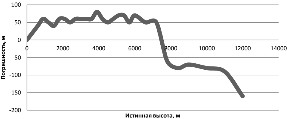
Рис. 1. Зависимость погрешности барометрического высотомера от высоты
