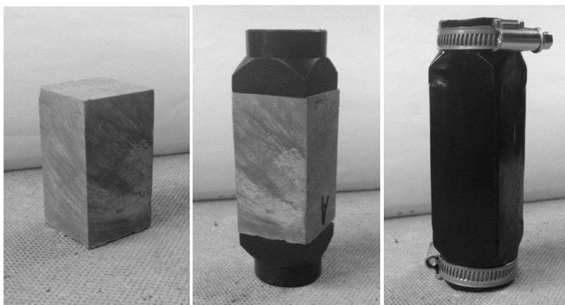
Рис. 1. Этапы подготовки образца для испытаний в камере объёмного нагружения
