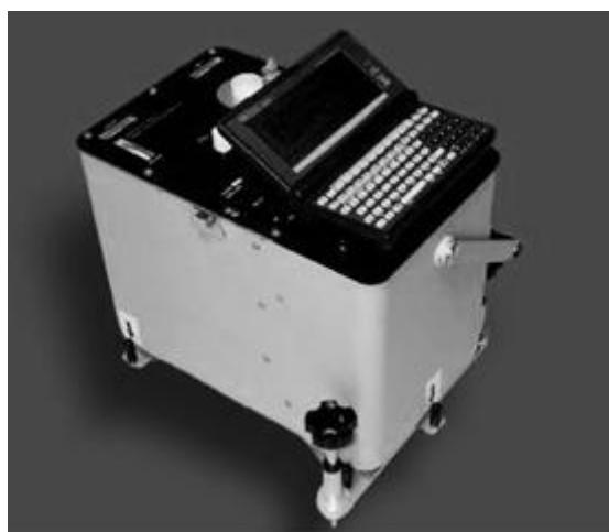
*Рис. 2. Burris Gravity Meter B-14*
