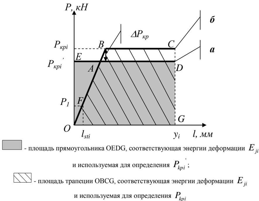
Рис. 1. Диаграмма деформирования стоек кузова:
