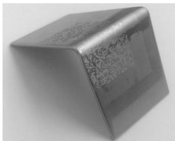
Рис. 5. Образец после испытаний на стойкость к МКК
